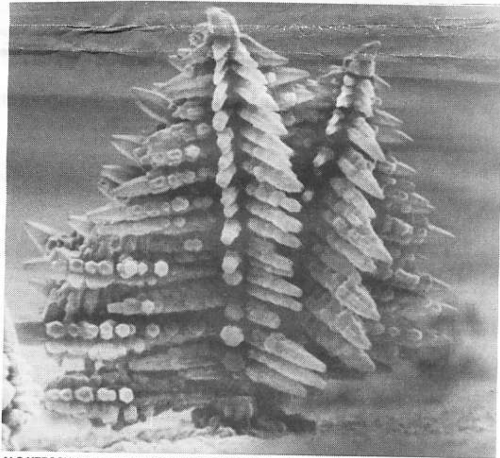
ALS VERSCHNEITE TANNEN erkennt das Super-Mikroskop eine Zink-Eisenschicht auf dem Kaltband.
